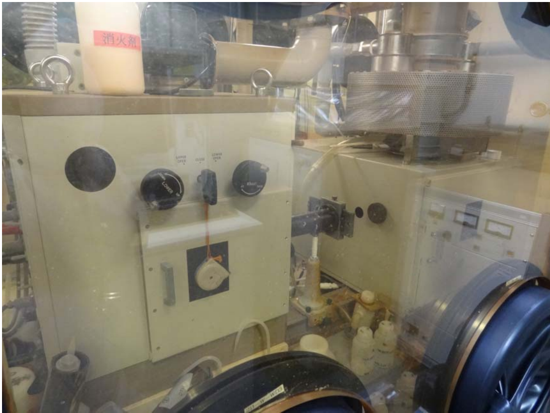
GB : 2 1 1 - W (金属不純物測定装置)【作業スペースの確保不可】
